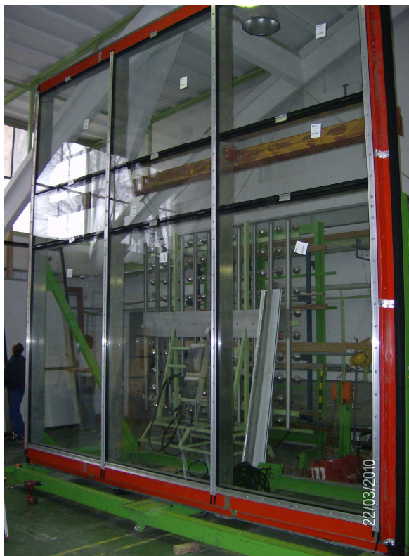
Fot.1. Ściana osłonowa MC WALL - widok od zewnątrz przed założeniem listew maskujących
